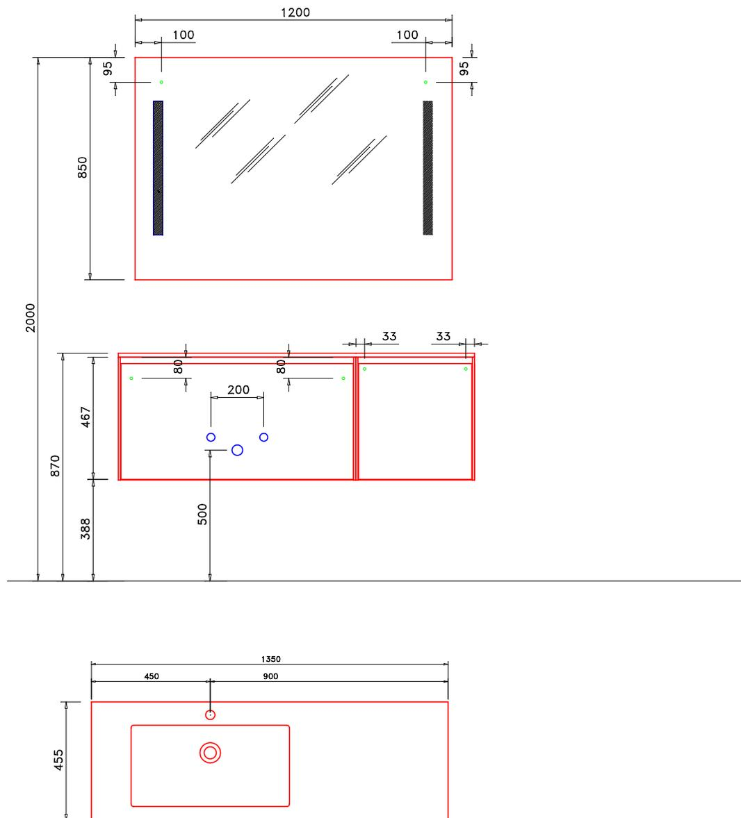
— Fori di fissaggio – wall fixing
